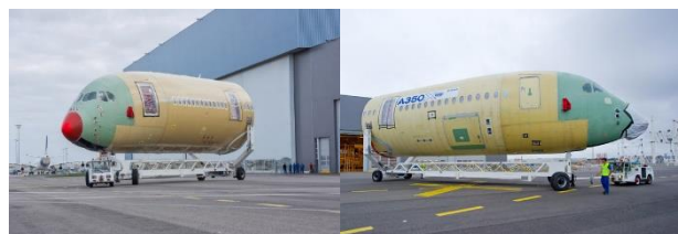
Gambar 3.5 Trolley dengan sumber tenaga penggerak tidak langsung
